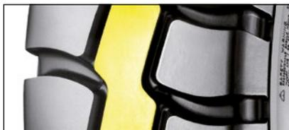
**Versetzt angeordnete Blöcke bieten Laufruhe und gleichmäßigen Abrieb**
