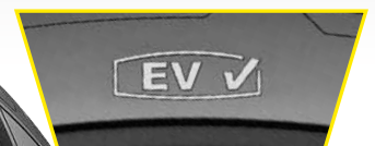
Preparado para vehículo eléctrico
